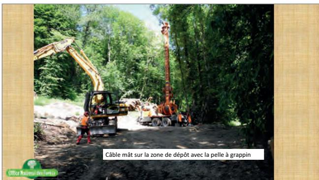
En ce qui concerne le débardage au câble, le mât est installé sur la zone de dépôt, et la pelle mécanique équipée d'un grappin reprend les bois et gère le dépôt. La particularité du chantier est d'avoir les lignes de câble en travers de la pente (et non dans l'axe de la pente). Ceci pour optimiser la surface et intégrer le seul accès possible pour évacuer les bois...
