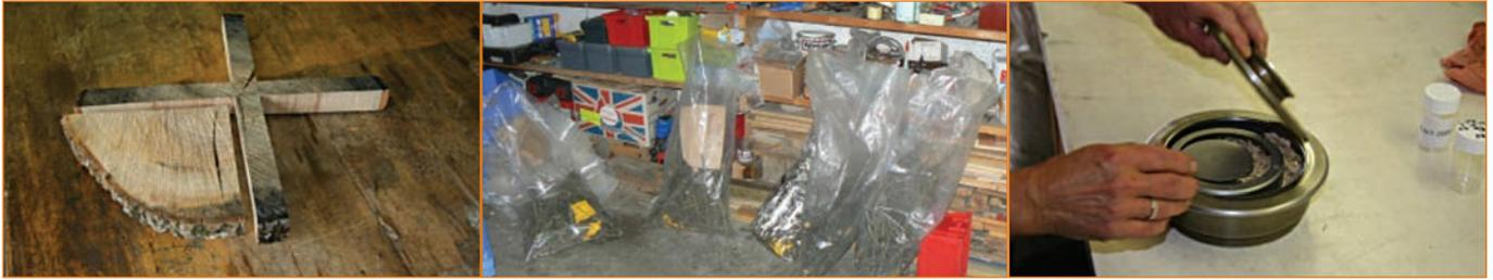
Fig. 9 : constitution d'échantillons standardisés pour les analyses minéralomasse sur les rondelles ou les menus bois, et à droite broyage fin des échantillons pour les mesures minéralomasse
