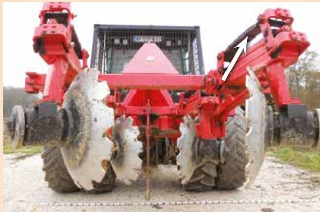
Les disques s'écartent vers l'extérieur dès qu'ils sont plaqués au sol. La paire la plus proche de la dent de sous-solage travaille le sol jusqu'à 20-30 cm maxi et réalise le petit bombé ; celle qui est en arrière travaille de même et réalise le grand bombé. Pour un bombé bien formé, la vitesse de déplacement doit être > 4 km/h, (mieux vers 4,5 km/h).
