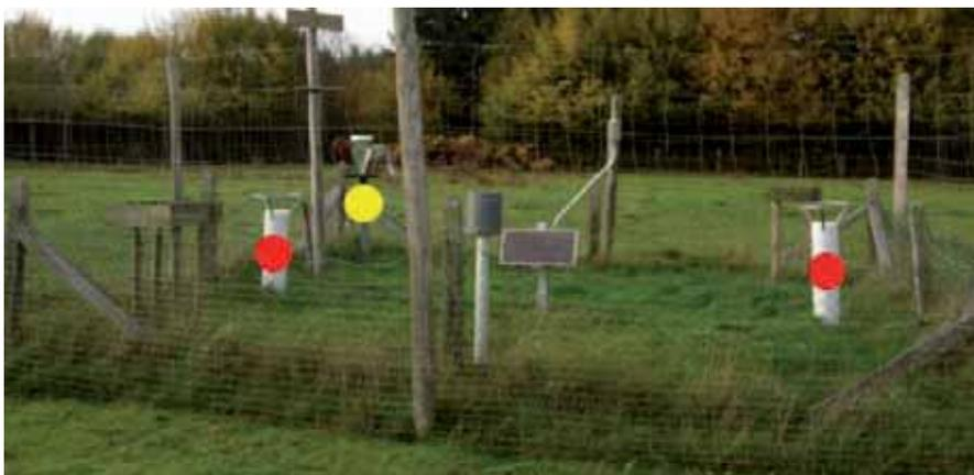
Dispositif de collecte de la pluviosité et des dépôts atmosphériques hors forêt (point jaune = Pluviomètre à lecture directe, points rouges = Collecteur de dépôts atmosphériques)
