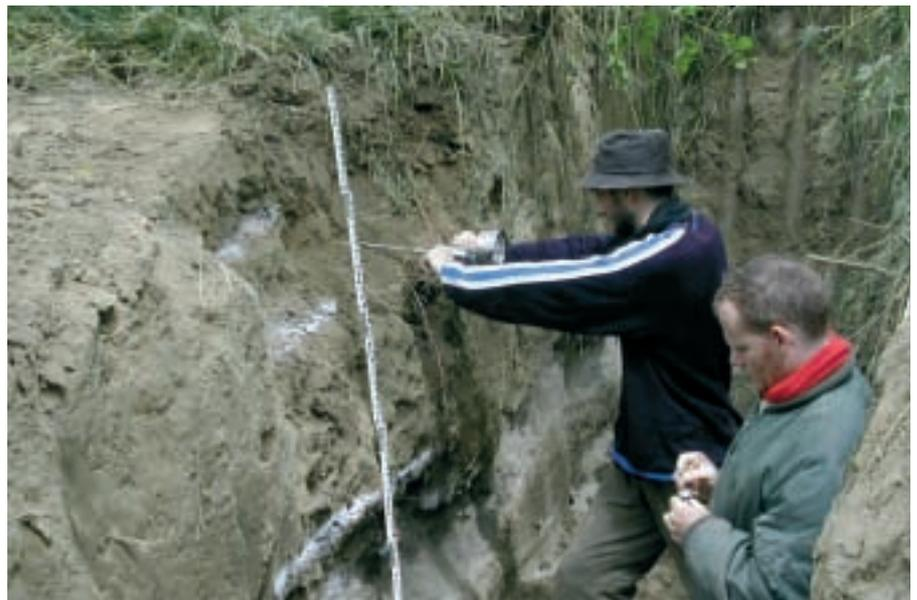
L'établissement de profils de résistance mécanique des sols permet d'expliquer une grande part de l'enracinement. Ici, tests au pénétromètre sur un sol alluvial de la Garonne, dans le cadre d'une étude IDF sur l'ancrage du peuplier
