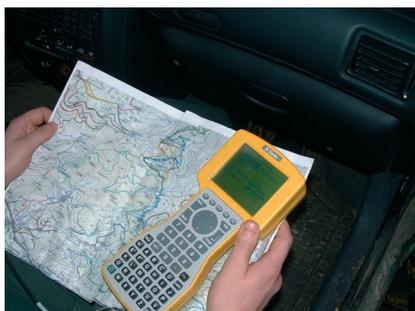
Fig. 1 : carnet de terrain du GPS Trimble
