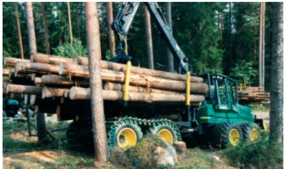
Pneus larges et basse pression, tracks sur le bogie arrière : une solution pour limiter les ornières sur des terrains plats et peu portants
