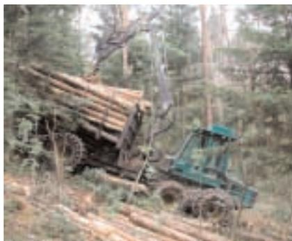
Circulation d'un porteur dans un cloisonnement sur sol en pente (Forêt communale de Taintrux, 88)
