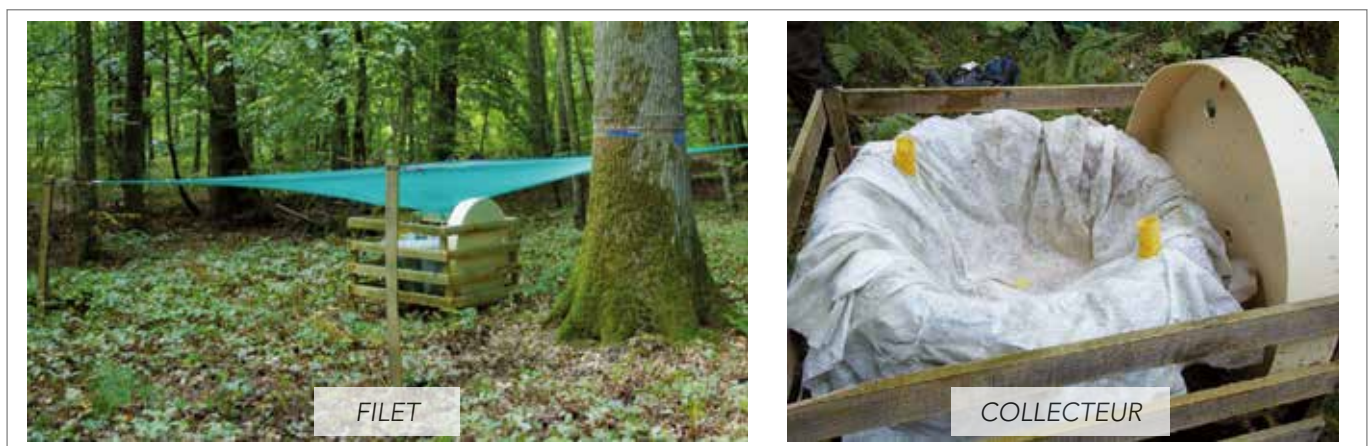
Fig. 4 : dispositif d'échantillonnage de collecte de fleurs et fruits des chênes suivis par le LBBE et l'ONF
