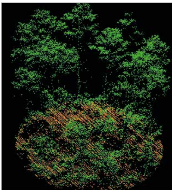
Fig. 3 : extrait du nuage de points LiDAR correspondant strictement à l'emprise d'une placette de calibration
