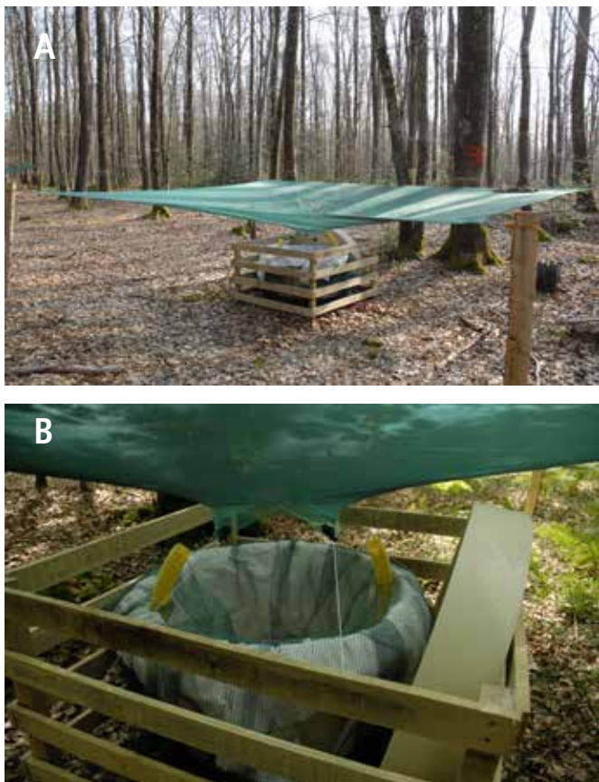
Figure 1. Dispositif de la méthode de collecte de glands dans les pièges ou méthode de référence
