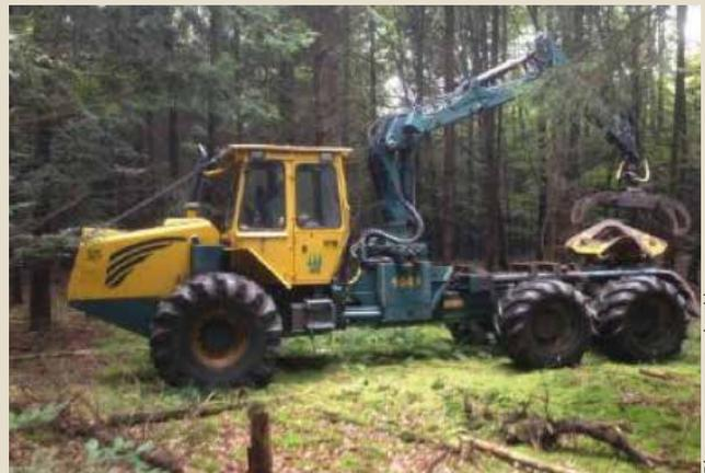
Débusqueur 6 roues avec grue, grappin et Klemmbank (HSM 904 F)
