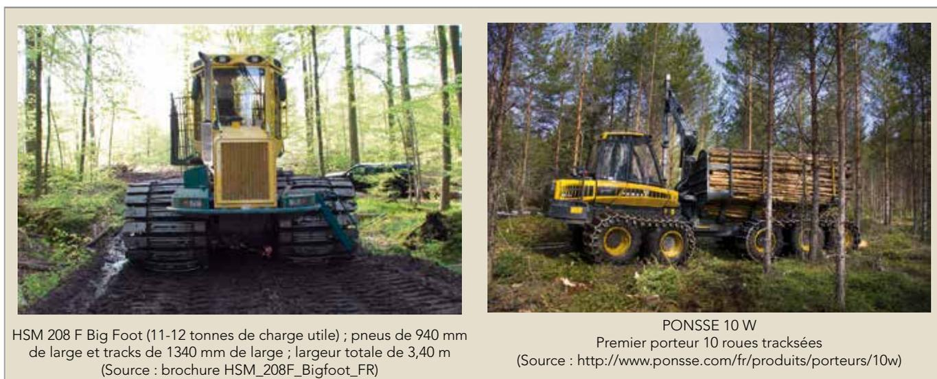
HSM 208 F Big Foot (11-12 tonnes de charge utile) ; pneus de 940 mm de large et tracks de 1340 mm de large ; largeur totale de 3,40 m (Source : brochure HSM\_208F\_Bigfoot\_FR)
