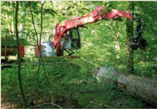
Rapprochement de grumes très lourdes et hors portée de la grue de 10 m, avec un câble sortant à environ 3,50 m du corps de la grue (force de traction : 8,5 tonnes)
