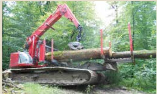
Lorsque le terrain n'est pas parfaitement plat, tout le poids porte sur une surface de contact réduite ; la pression au sol y est concentrée, sans forcément créer d'ornière
