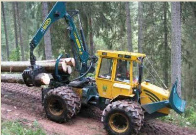
Débusqueur 4 roues à grue et grappin, avec Klemmbank et roues jumelées (HSM 805)
