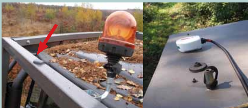
Petite antenne de GENITRONIC et grande antenne d'ISAGPS fixées par aimant sur le toit ou blindage du tracteur
