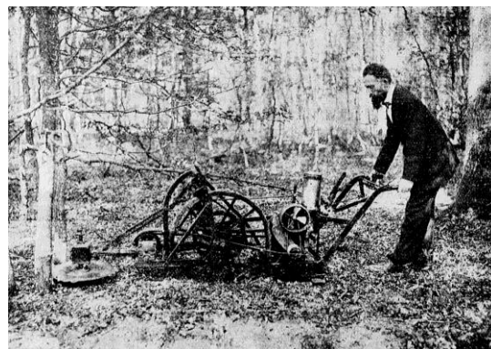
Illustration 20 : première abatteuse-billonneuse nommée « la Bûcheronne » inventée par M. Pioche et testée en forêt de Meudon dès 1915.
