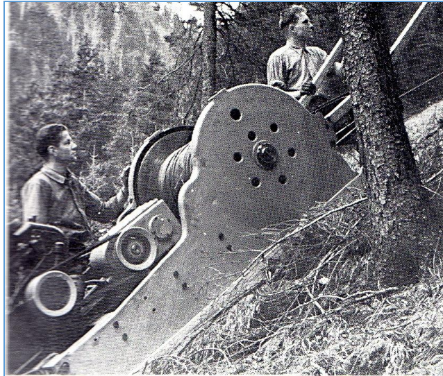
Illustration 83 : système Wyssen (haut : source : Poncet, 1964 ; bas : source : Wyssen, 1972)
