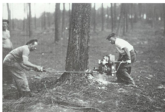
Illustration 32 : scène d'abattage avec une tronçonneuse à deux hommes de marque REXO (première tronçonneuse française construite à Thiers dans le Puy de Dôme vers 1947). Il fallait deux personnes pour manier cet engin. L'une tenait une poignée pour guider la lame tandis que l'autre soulevait la poignée du moteur. Robuste, puissante mais relativement lourde (30 kg !). Source Wikimedia Commons.
