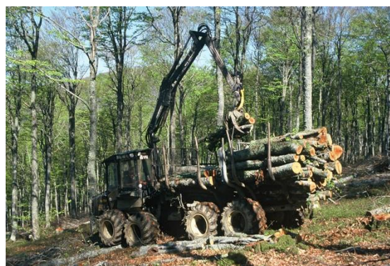
Illustration 39 : chargement du bois par un tracteur porteur en 2001. © P. Cadiran.
