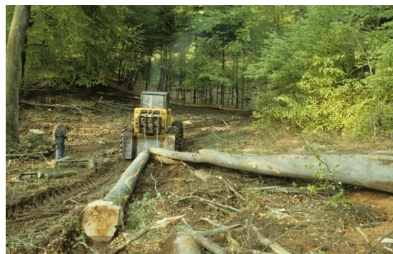
Illustration 37 : débardage par traînage au moyen du câble du treuil arrière d'un tracteur forestier dans les années 1960. © J.C. Chasseau, ONF.
