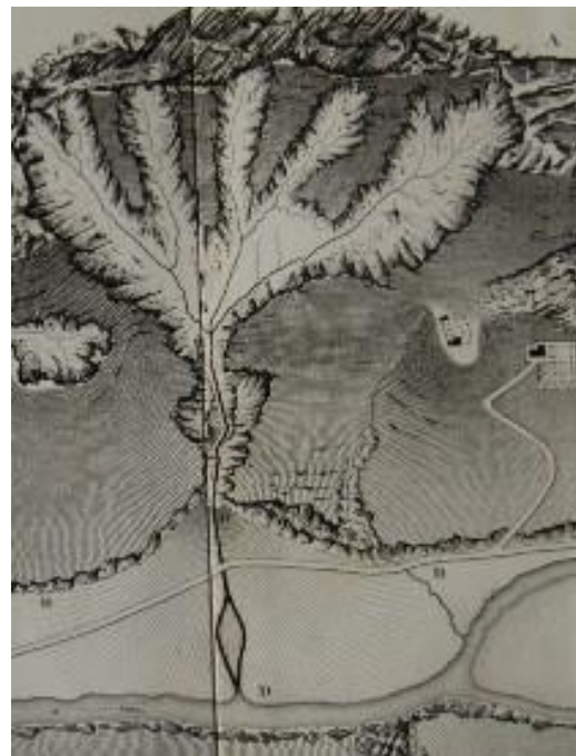
Illustration 200 : schéma de principe d'un torrent. Surell. 1841.
