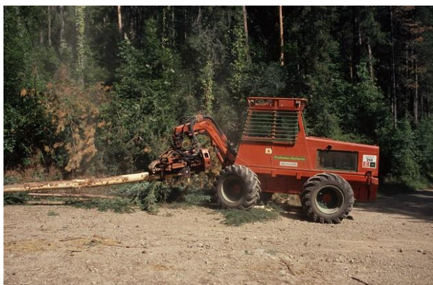
Illustration 34 : Ebrancheuse de la fin des années 1960 en cours d'ébranchage.
