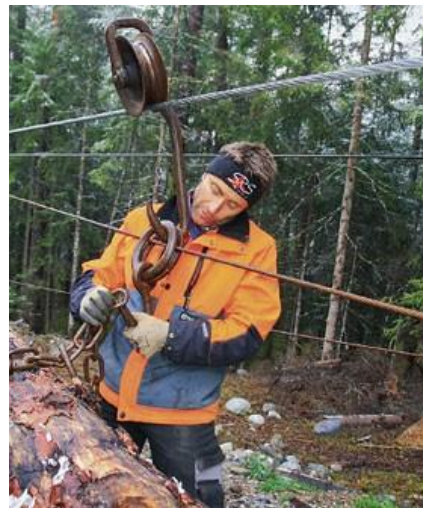
Illustration 75 : station aval du tri-câble à Sent (source : Riatsch, 2009)
