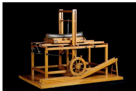
Illustration 10 : reconstitution de la machine à scier le bois de 1478 de Léonard de Vinci. L'eau coule dans un petit canal au-dessous de la machine et fait tourner la roue à godet. Cette roue transforme l'énergie nécessaire pour actionner le système de poulie. Wikimedia Commons.
