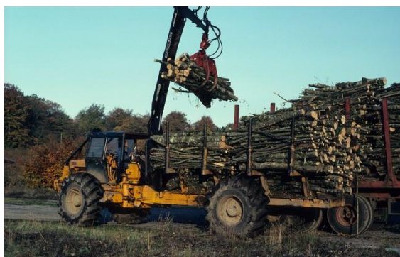
Illustration 38 : porteur chargeant avec une grue à grappin des bois moyens, fin des années 1960. © J.C. Chasseau, ONF.
