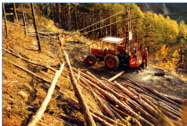
Illustration 92 : système de câble Igland 203 interlock (Norvège)
