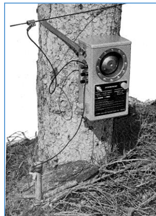
Illustration 96 : système de téléphone de terrain (source : Wyssen, 1972)
