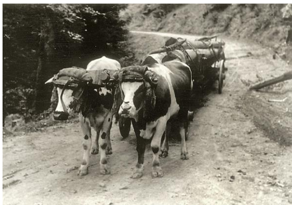
Illustration 17 : traînage de grumes par triqueballe tirées par deux bœufs.
