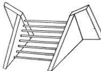
Illustration 210 : système Genet, barrage de correction torrentielle articulé 1955
