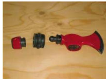
*Prototype avec dissociation de l'empreinte du reste du fer et insertion d'un dispositif de compensation d'angles*
