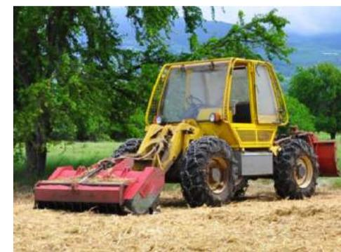
**Broyeur monté sur un tracteur**
