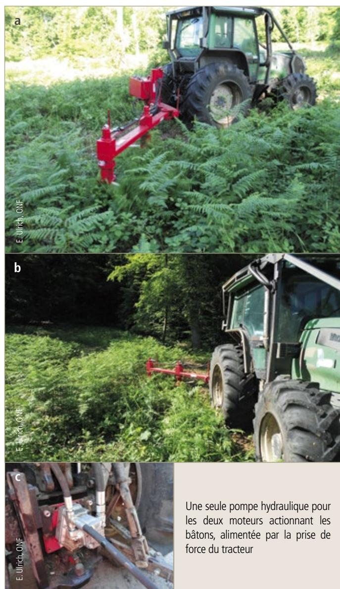
**Figure 2 : deuxième prototype de bâtonneur mécanisé (mai 2014) ; solution non retenue**
