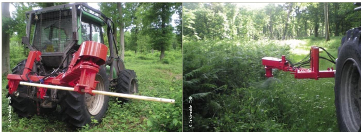
Figure 1 : premier prototype de bâtonneur mécanisé (juin 2013) ; solution non retenue
