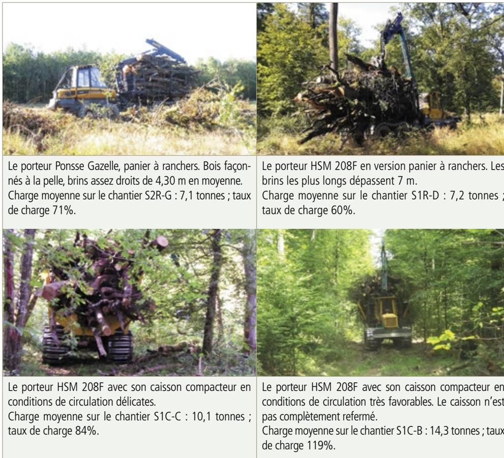
Figure 7 : chargement en différentes configurations
