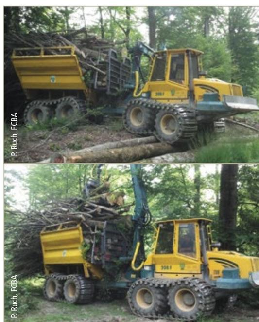
Figure 2 : le porteur HSM 208F équipé du caisson compacteur en position ouverte (en haut) et fermée (en bas)
