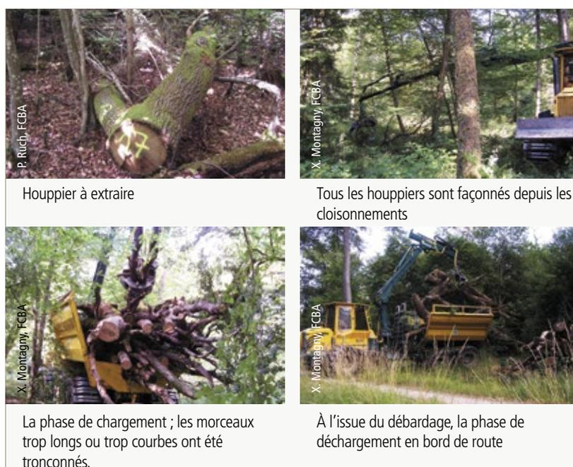
Figure 3 : illustration du système à 1 engin sur le chantier de la coupe d'amélioration en forêt domaniale de Fénétrange, parcelle 191
