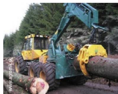
Figure 6 : débusqueur à grue (télescopique) et à pince (ici avec grume de résineux)
