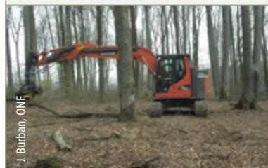
Façonnage de houprier (billons et tout venant) avec une pelle équipée d’un grappin scie
