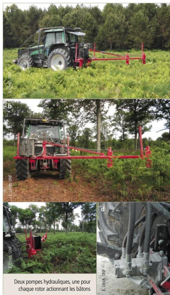
**Figure 3 : troisième prototype de bâtonneur mécanisé (mai 2015) ; solution non retenue**
