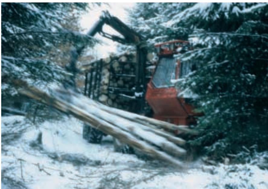
Dans un porteur, la grue, les moteurs des roues et l'articulation centrale sont tributaires des fluides hydrauliques
