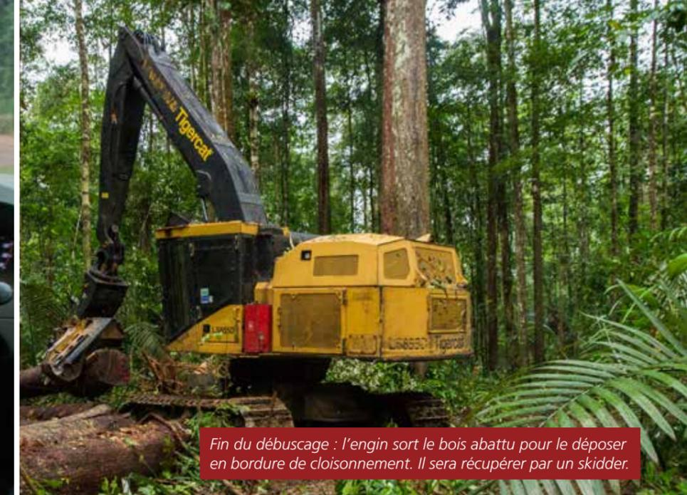
Fin du débusquage : l'engin sort le bois abattu pour le déposer en bordure de cloisonnement. Il sera récupéré par un skidder.
