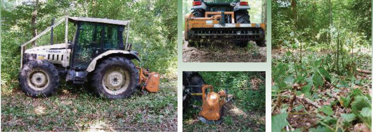
Le gyrobroyage superficiel (machine de type « Forest Master ») est une méthode envisageable pour traiter les fourrés denses. Cette technique a l'effet d'une fauche. Utilisé seul, ce traitement n'est pas très efficace car il laisse des fragments de tiges qui vont générer de nombreux rejets. De même, le passage de la machine va coucher un certain nombre de tiges susceptibles de donner plus tard des rejets verticaux.
